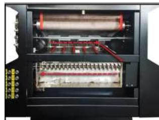
Automatische Pulverentnahme und Recycling
