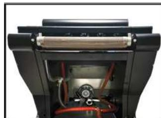
Vakuummatte zur Reduzierung des Papierverlustes bei Druckbeginn und -ende
